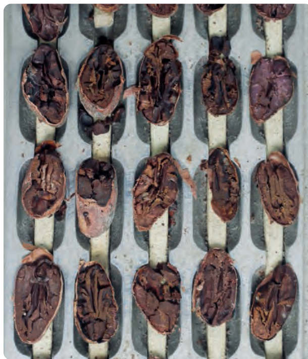
Mit dem Cutter werden die Kakaobohnen aufgeschnitten. An der Farbe, Konsistenz und dem Geruch der Bohnen kann man die Qualität erkennen.
